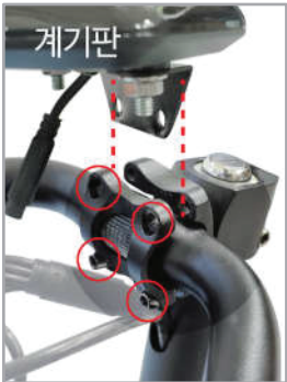
3. 분리된 스템 사이에 볼트를 이용하여 핸들부터 가결합 후, 계기판도 스템에 결합 후 볼트를 조여 주시면 됩니다.
